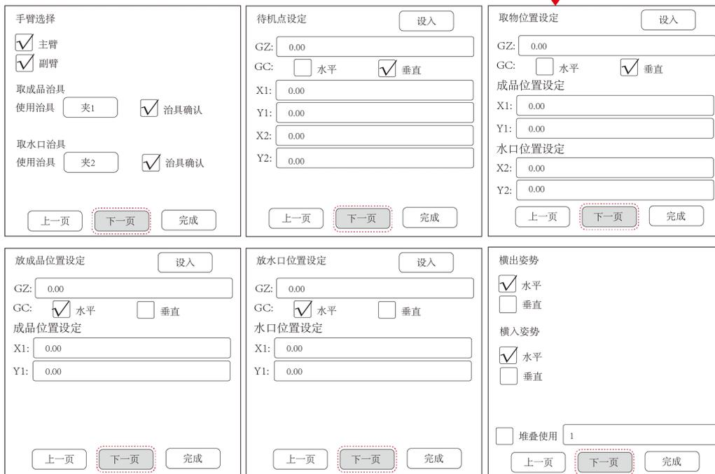
如上图所示，程序快速设定，可以只设定位置和选择动作。程序即可自动生成可执行的程序，
