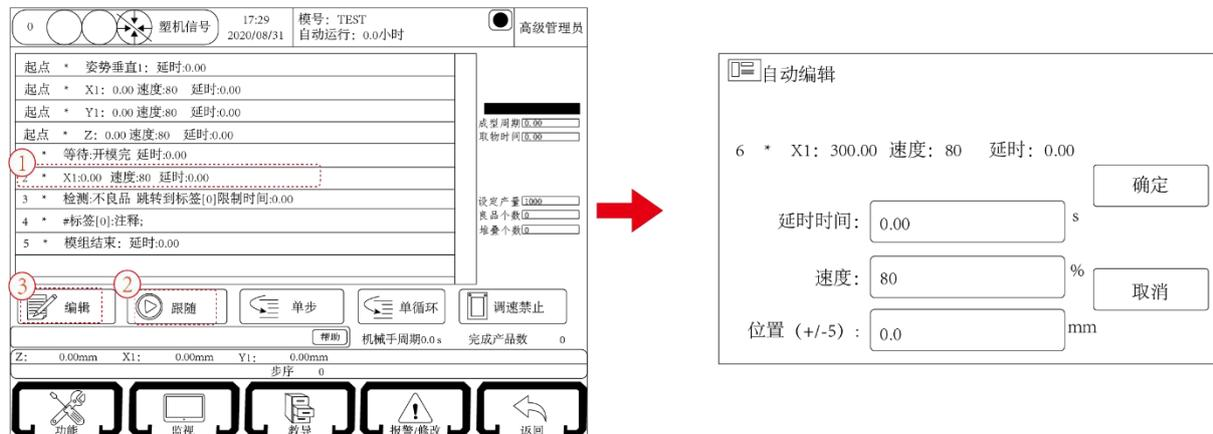
在该对话框可修改该动作的延时时间、电动轴的速度和位置，更改参数后再点击“确定”键，参数会被在线接受，从下个循环开始会按更改后的参数运行，若要取消该动作可按“取消”键。
