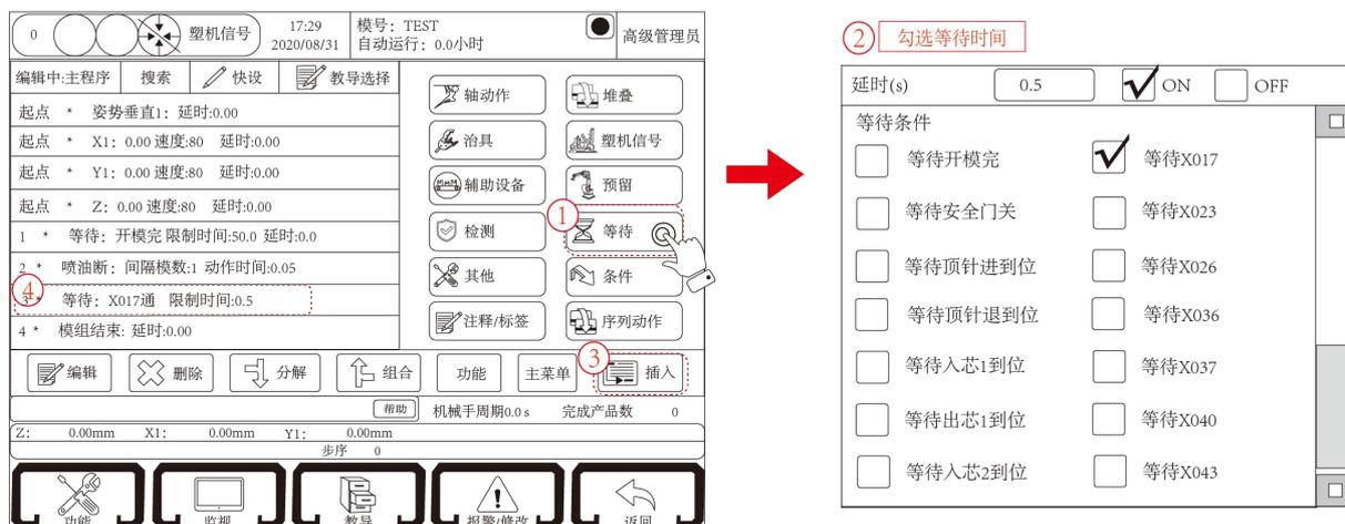
每一个自动运行的程序必须包含“等待开模完”程序步，新建一个程序已默认包含此程序步，不可对其进行删除。
