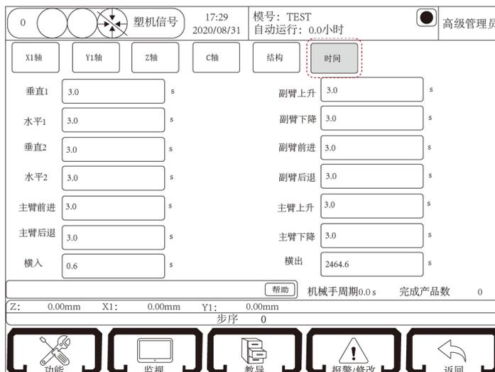
在该页面下可以设定各轴动作的限定时间, 各轴动作的时间超过此设定值仍没有相应的输入信号即报警。(气动轴才有效)
